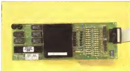
La più interessante delle schede è questa IC Test Card che permette di provare l'efficienza di altri 308 integrati su TTL che CMOS e se serve di scegliere la serie di un integrato di cui non si conosce il tipo. La prologica che si vede nella foto permette di cambiare pochi fili dell'Apple in piccolo apribile di lavoro per cui si possono provare anche grossi stack di integrato in un tempo molto breve.
